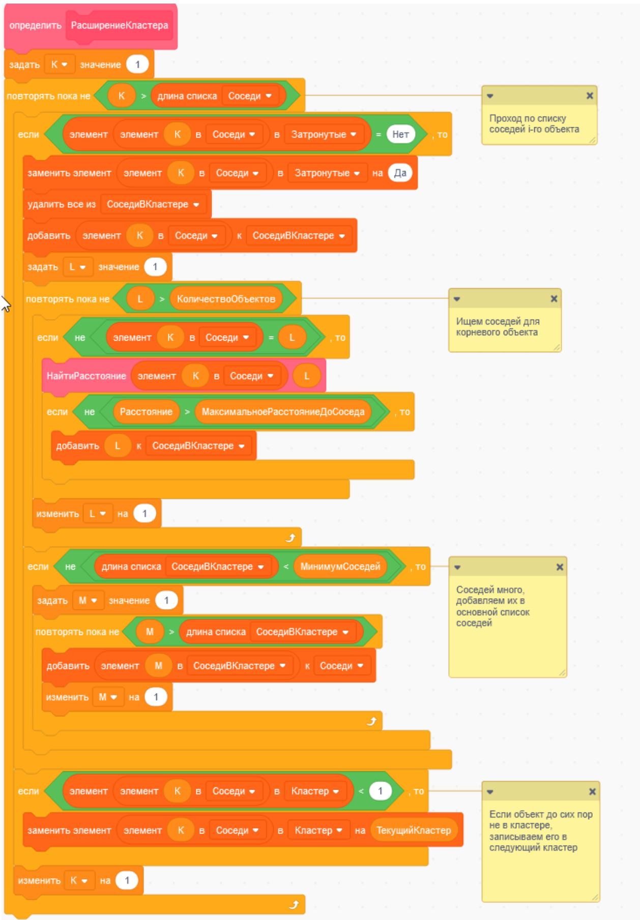
Рис. 4. Scratch – код подпроцесса для расширения кластера
